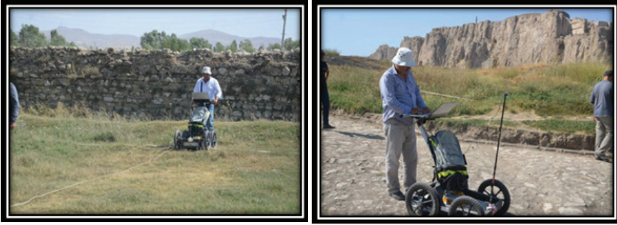
Resim 2. Eski Van Şehri sokak dokusunu ortaya çıkarmak için, kazılarda kısmen ortaya çıkarılan yolun devamı için GPR ölçümleri
