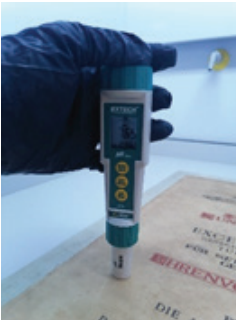
Foto. 51. pH metre ile ölçüm (B. Özdemir arşivi)
