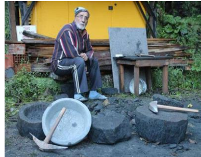
Resim 7: Pileki taşı adı verilen ve belirli alanlardan çıkarılan özel bir taşın el işçiliği ile oyulması ile yapılan bir pileki örneği ve son ustalardan İyidereli Mustafa Yılmaz.
