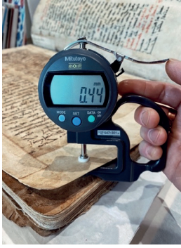
Fig. 37. A grubu kalınlık ölçümü
