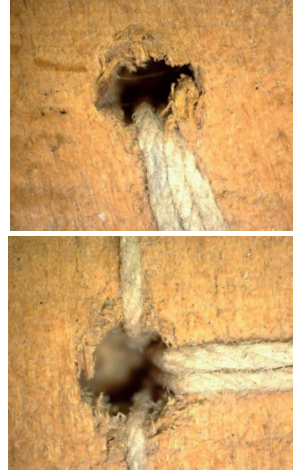
Fig. 11. Forma ve kolon dikiş delikleri
